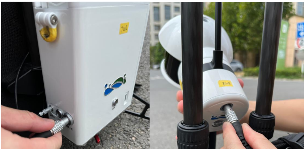
图 2-11 连接电源线（MAIN 口）
