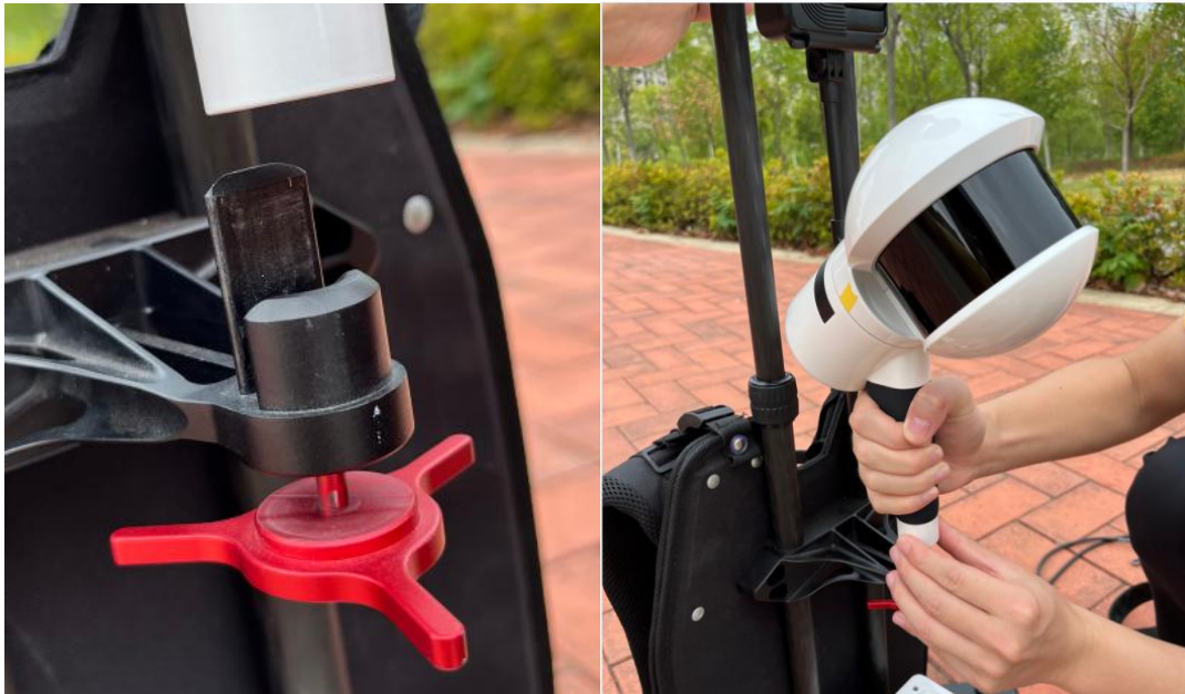
图 2-9 手持底部对准顶部插入，拧紧螺丝
