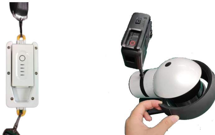
图 2-3 连接背带，取下保护罩
