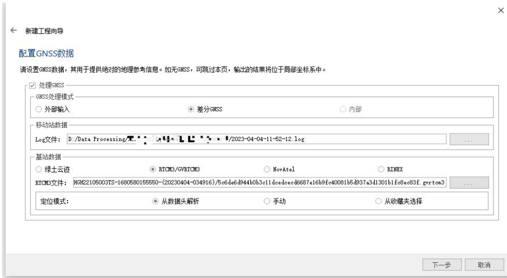
图 7-9 RTCM3/GVRTCM3 虚拟基站数据解算
