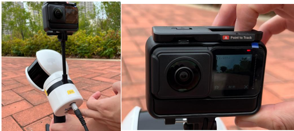
图 5-9 先停止激光器再停止记录相机
