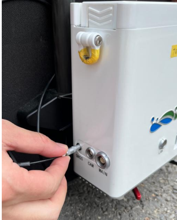
图 2-10 GNSS 线插入电池盒的 GNSS 口
