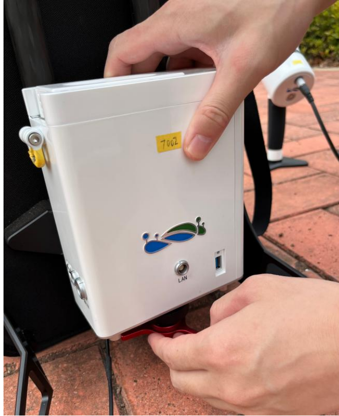
图 2-6 电池盒对准底部螺丝，拧紧
