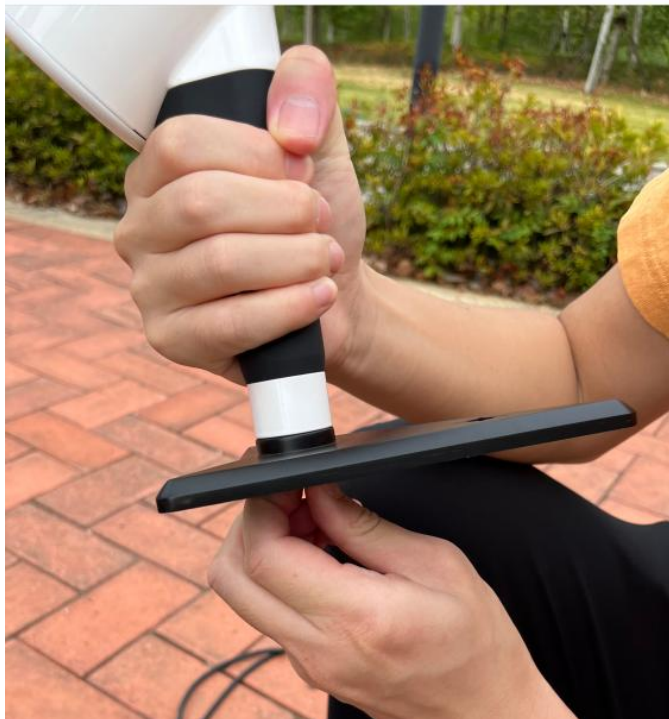
图 2-7 拆卸打点底座
