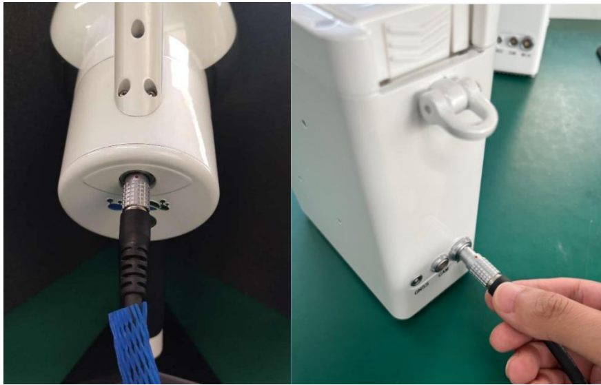
图 2-2 主机电源线连接手持设备主机和电池盒（MAIN 口）
