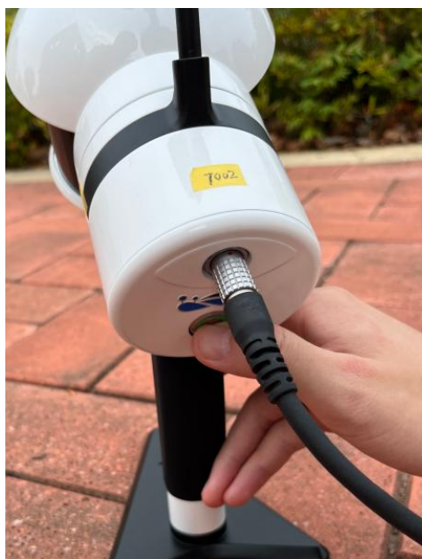
图 5-5 长按按钮进行初始化
